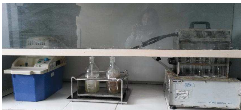
Foto 3. Proceso de digestión, en una sorbona (tipo de extractor de gases)
