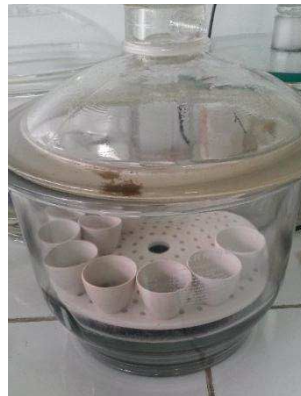
Foto 7. Resultado de muestras de ceniza (crisoles) en un desecador, para ser pesadas.
