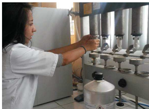
Foto 2. Extracción de grasa, método Soxhlet
