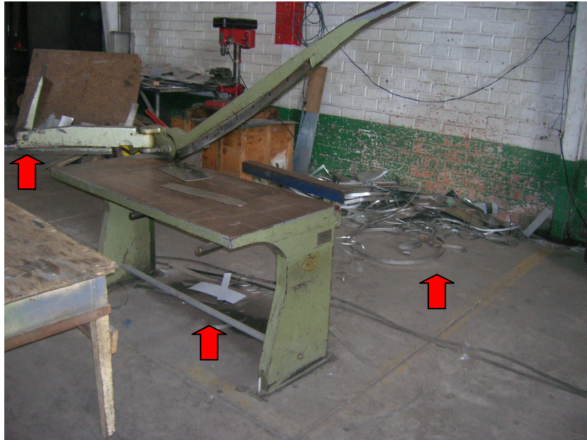
Imagen 3.10: Desperdicios de materiales en el suelo
