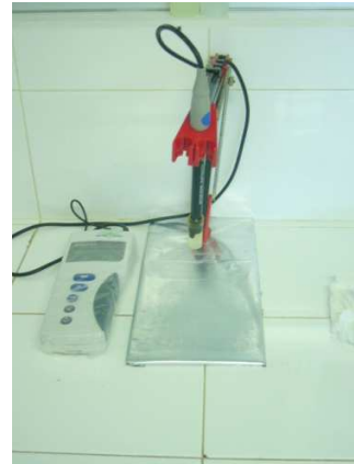
Figura 3.5 pH-metro. Instrumento para determinar pH
