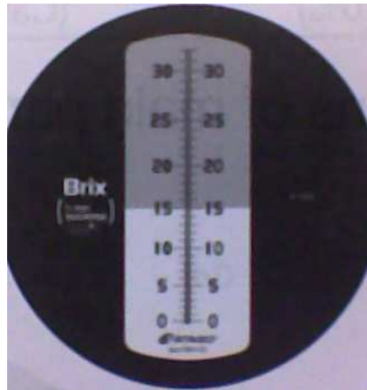
Figura 3.10 Escala graduada en el interior del lente del refractómetro manual
