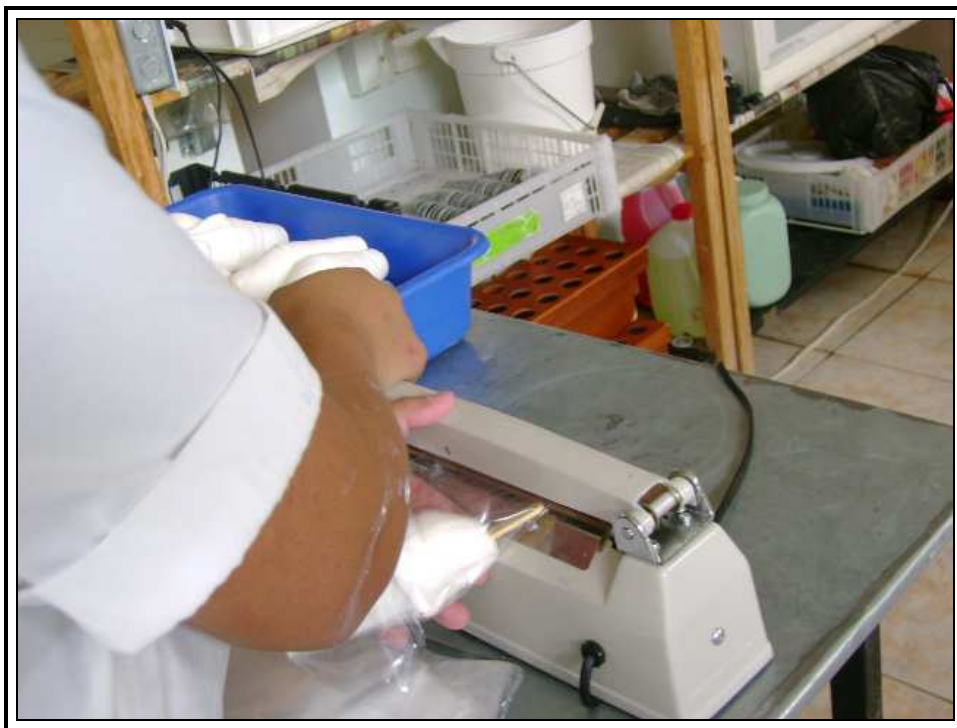
Figura 4.16. Enfundado de paletas de helado Fuente: Planta de la Heladería Toffee ice cream Fotografía: Adriana Robalino, Carlos Silva.
