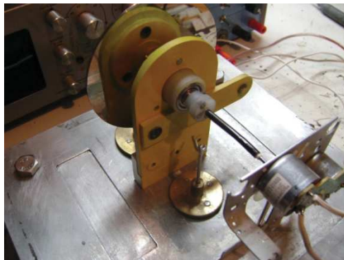
figura 3.12 Acople del motor eléctrico y Stirling
