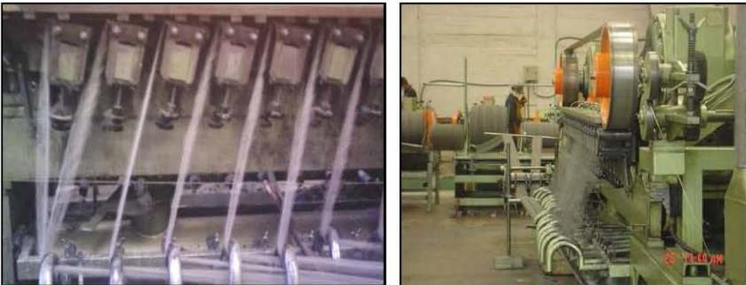
Figura 4.7 Desgarrado de lana de acero
