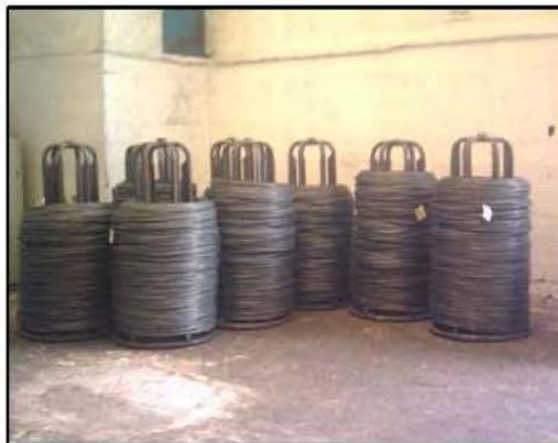
Figura 4.5 Alambre para trefilación 2.65mm
