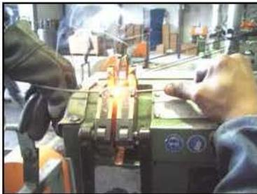
Figura 4.22 Suelda de alambre
