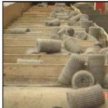
Figura 4.9 Lana de acero cortada y enrollada (Esponjilla)
