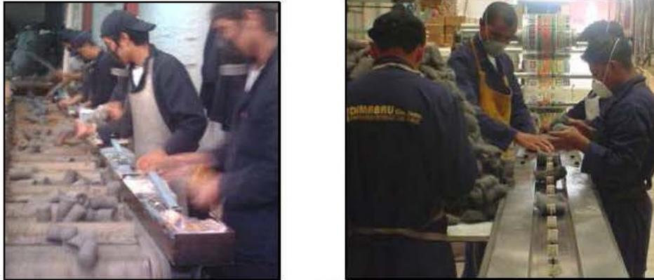
Figura 4.10 Empaque manual (izquierda) y automático (derecha)
