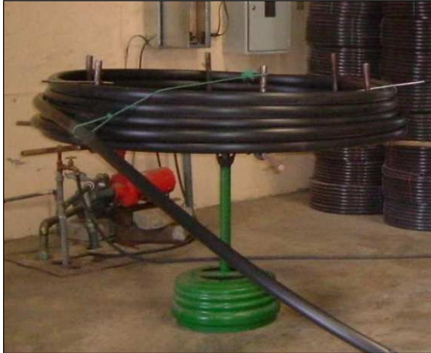
**Foto 3.14 Enrollador de manguera terminada.**
