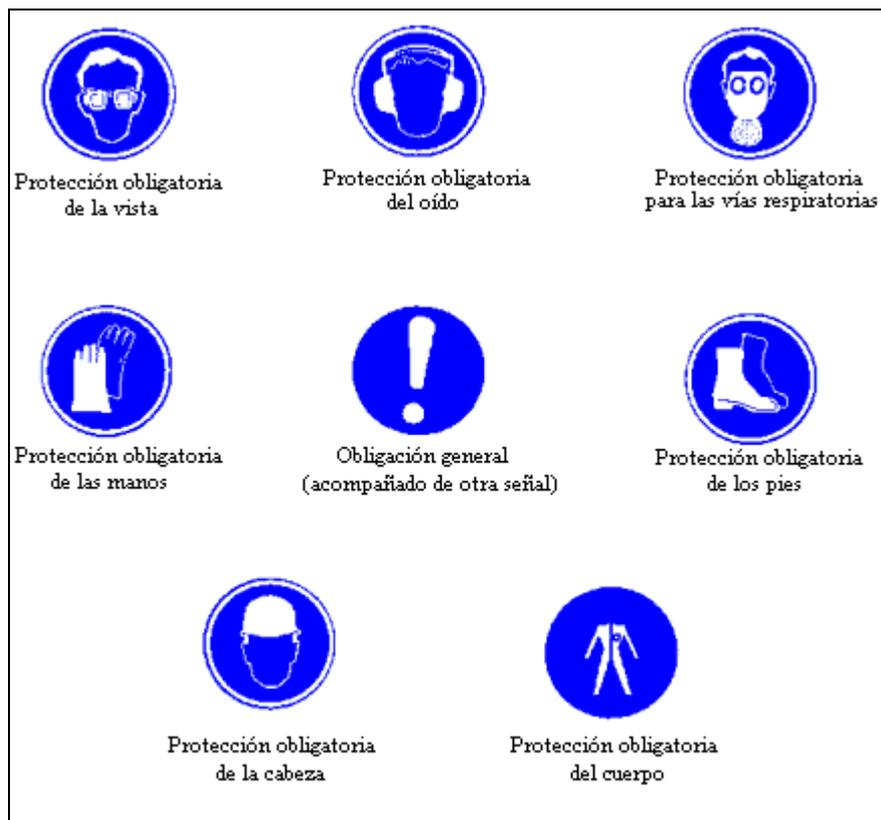
**Figura 5.4 Señales de obligación. Planta ECOMANGUERA.**
