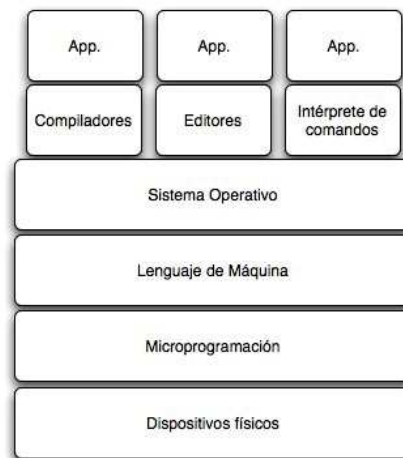
Fig. 1.1 Elementos de un sistema de Computo 3
