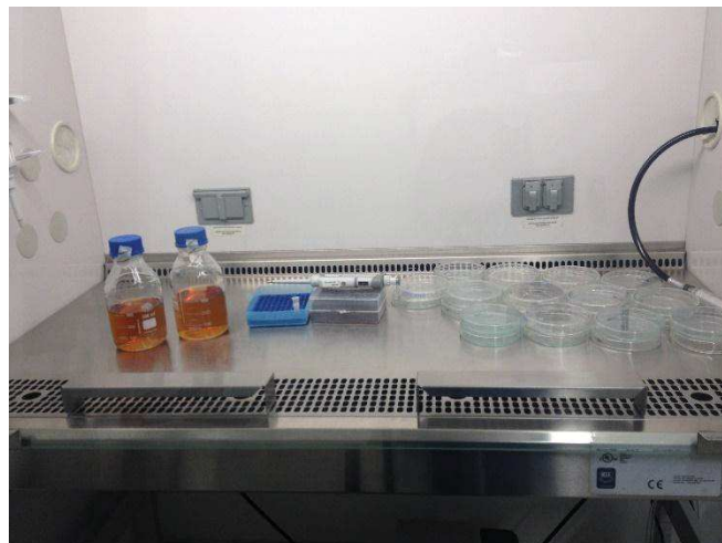
Figura 5. Agar TYS20B en la cámara de flujo laminar para su traspaso a las cajas Petri.
