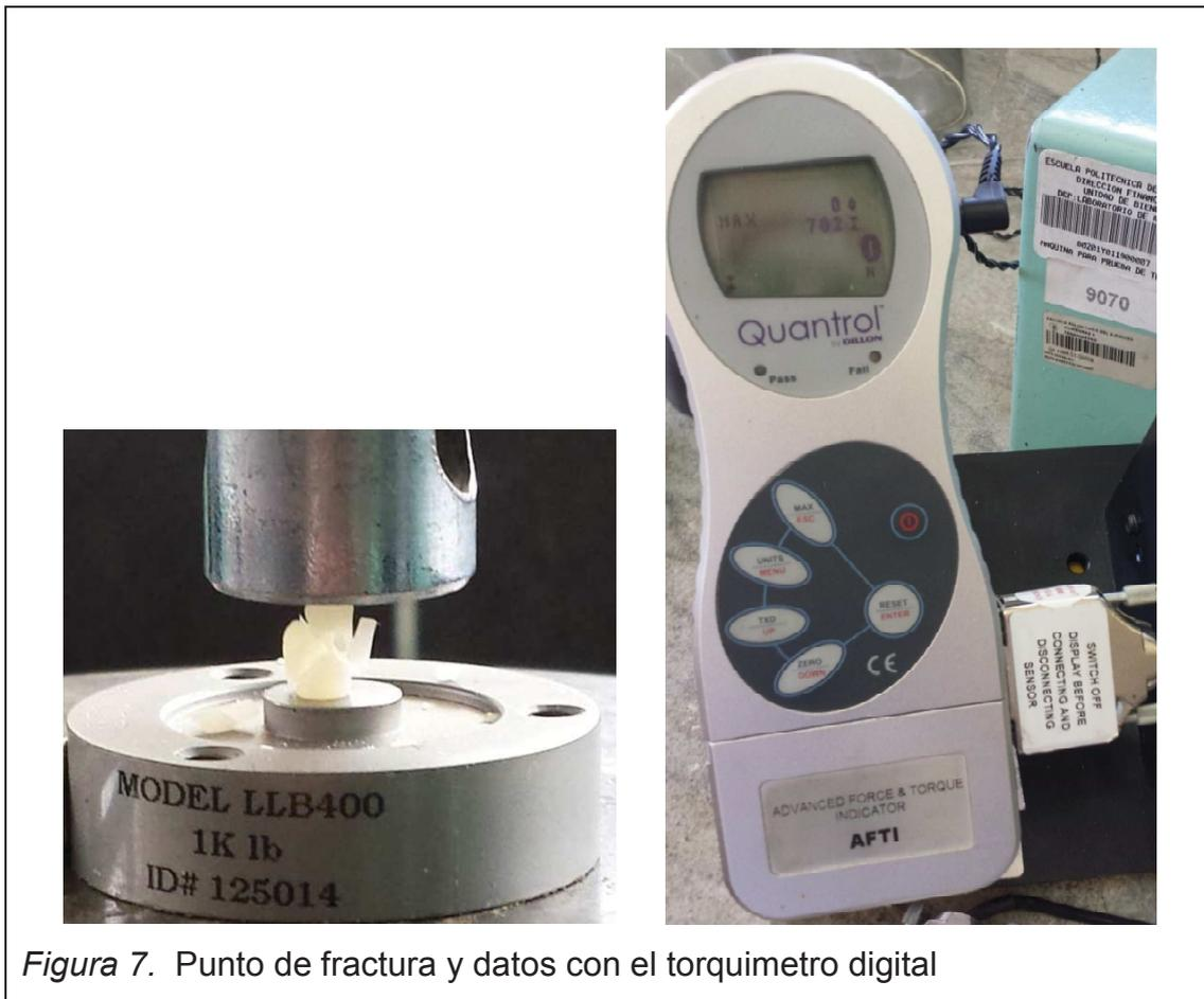
Figura 7. Punto de fractura y datos con el torquimetro digital
