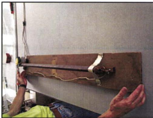
**Figura 6.3.** Construcción de una dobladora artesanal de acrílico.
