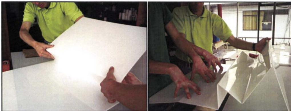
Figura 6.5. Primeros doblajes del acrílico.
