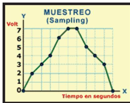
Figura 44: Muestreo de Señal analógica
