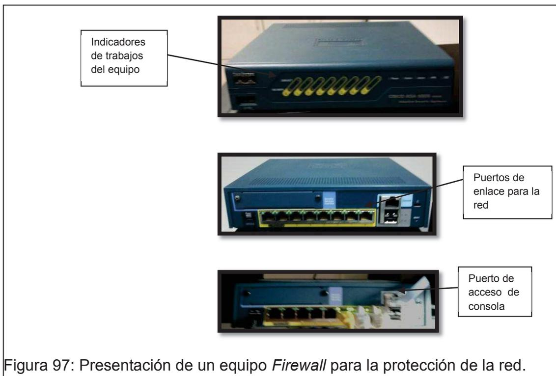
Figura 97: Presentación de un equipo *Firewall* para la protección de la red.
