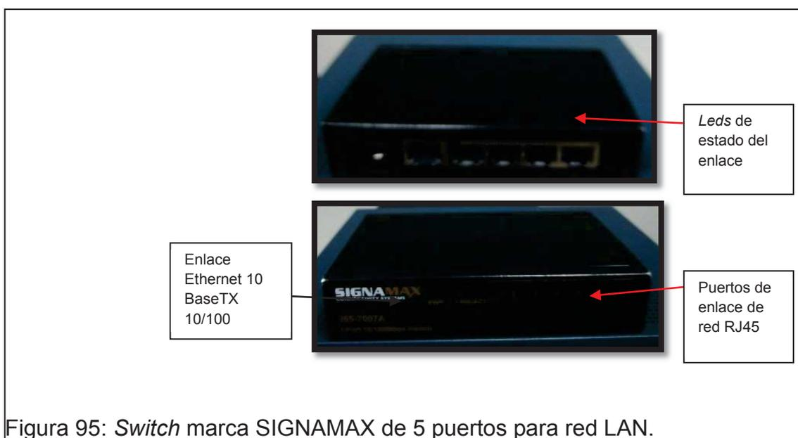
Figura 95: Switch marca SIGNAMAX de 5 puertos para red LAN.
