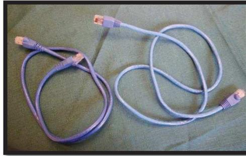
Figura 19: Cable cat.6 que se utiliza.
