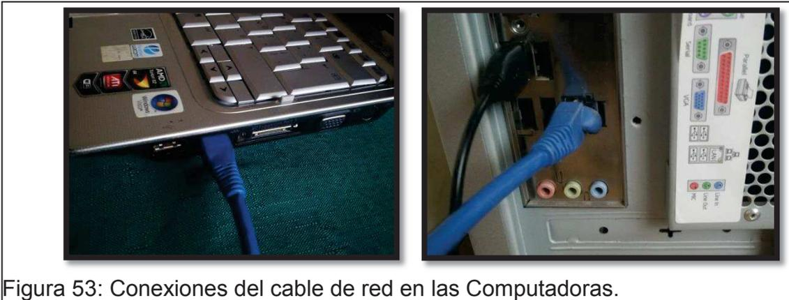
Figura 53: Conexiones del cable de red en las Computadoras.
