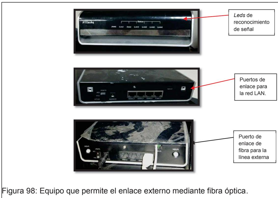
Figura 98: Equipo que permite el enlace externo mediante fibra óptica.
