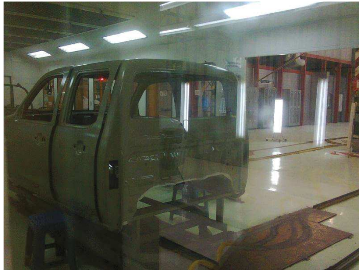
Figura 7. Cámara de limpieza
