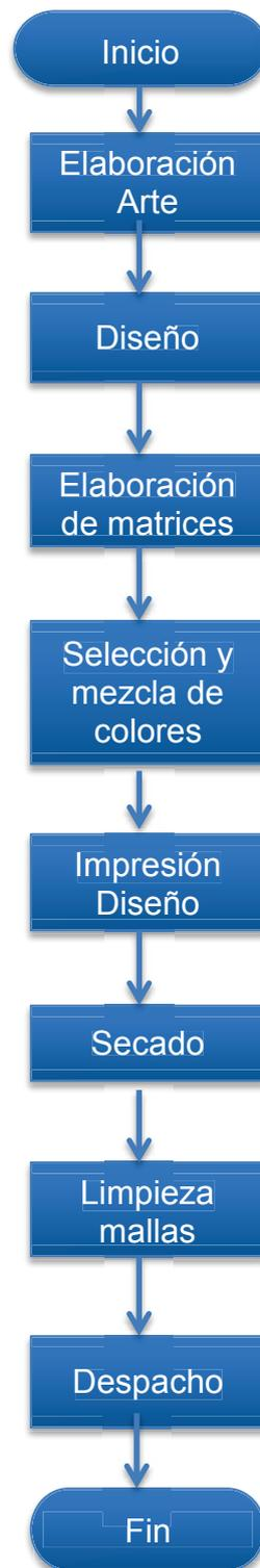
Figura 10. Diagrama de Flujo del Proceso de Serigrafía
