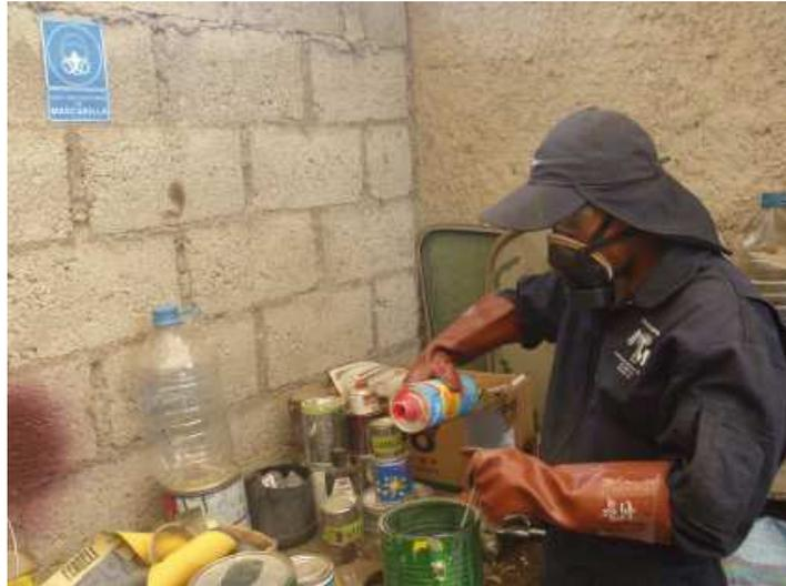
Figura.14. Guantes de Pvc, mascarilla, gafas protectoras, gorra de protección, para la manipulación de pinturas
