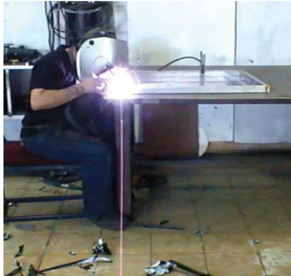
**Figura 8:** Suelda de refuerzos en el interior del tablero de la Mesa de Trabajo
