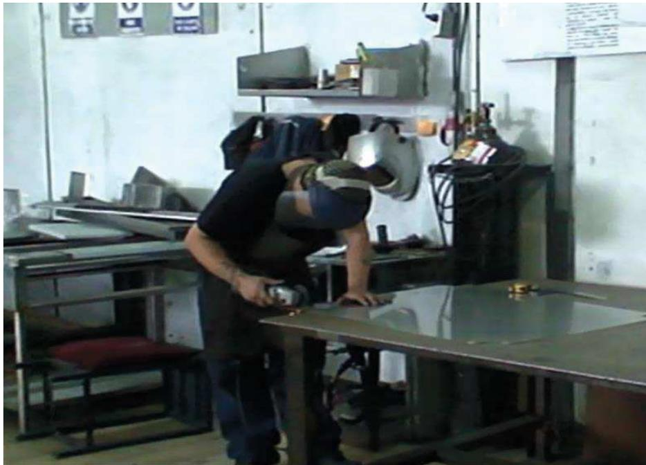
**Figura 6:** Corte de las esquinas del tablero principal de la Mesa de Trabajo
