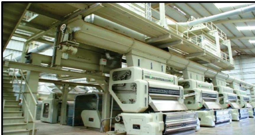
**Figura 1.** Máquina despepitadora de algodón
