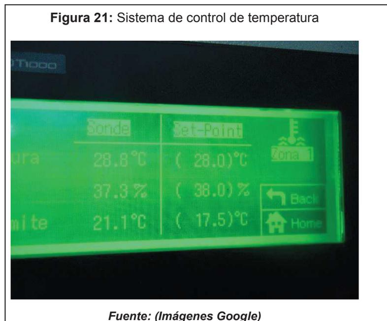
El objetivo del control de temperatura es reducir la humedad y mantener un clima estable para la elaboración de las hilas, debido a que en un ambiente demasiado húmedo, la materia prima tiende a formar motas y generar desperdicio, mientras que en un ambiente extremadamente seco o caluroso produce el rompimiento excesivo de del algodón.
