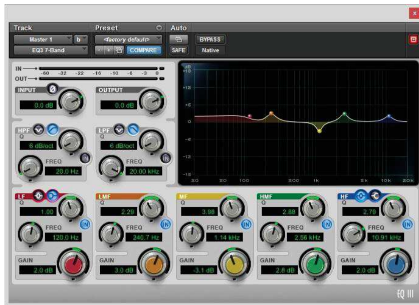
Figura 15. Ecualizador EQ3 7-Band usado en el proceso de mastering .
