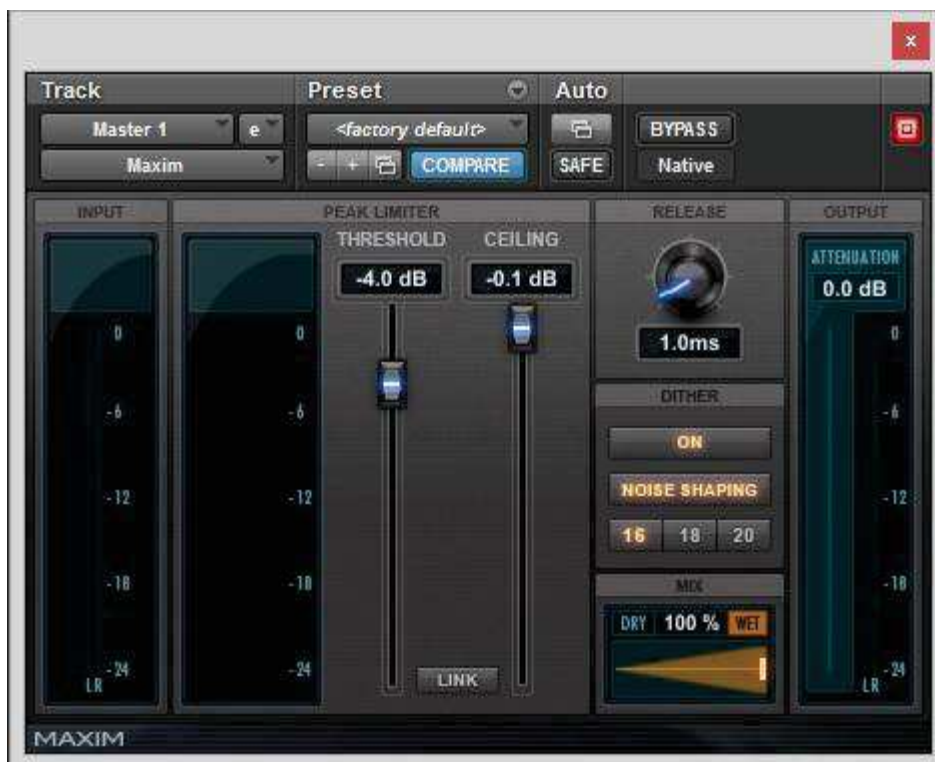
Figura 18. Maximizador Maxim usado en el proceso de mastering .
