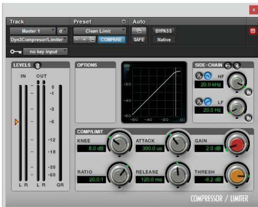
Figura 17. Dyn3 Compresor/Limiter usado en el proceso de mastering .
