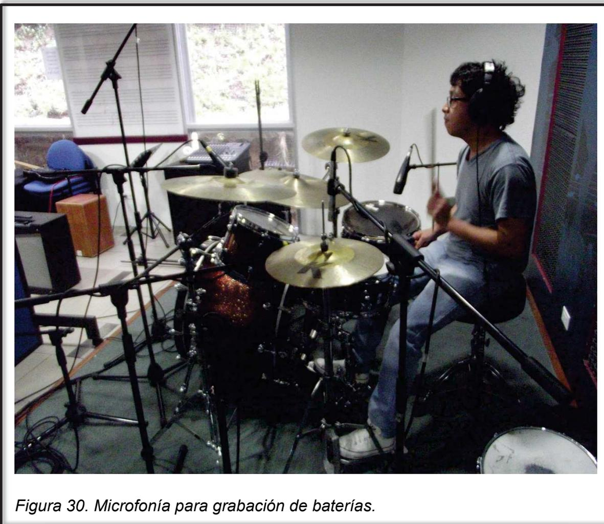
*Figura 30. Microfonía para grabación de baterías.*
