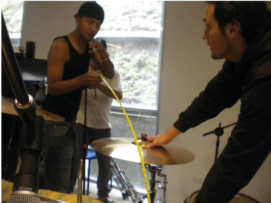
*Fig.25: Fotografía lateral de la batería donde se aprecia la medición para la colocación del micrófono Shure KSM 137.*
