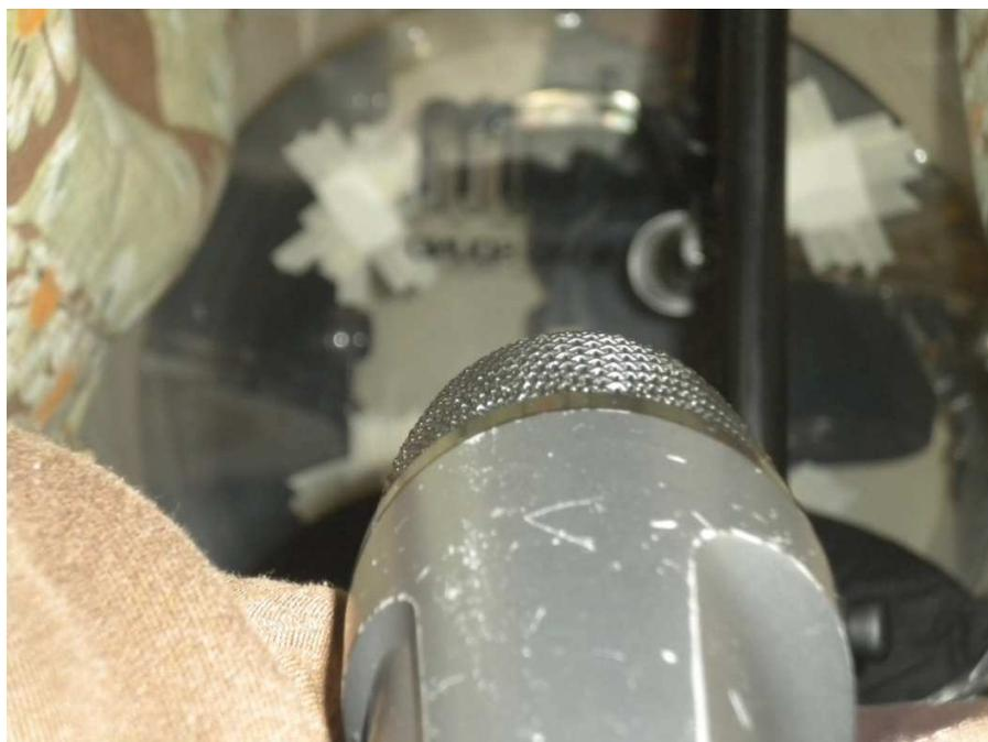
*Fig.9: Fotografía del túnel artificial creado para obtener el sub-kick realizado con una cobija. Vista interna del túnel donde se aprecia el micrófono Sennheiser E602 de cerca.*
