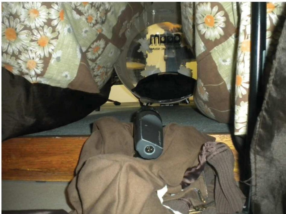
*Fig.7: Fotografía del túnel artificial creado para obtener el sub-kick realizado con una cobija. Vista interna del túnel donde se aprecia el micrófono Sennheiser E602.*
