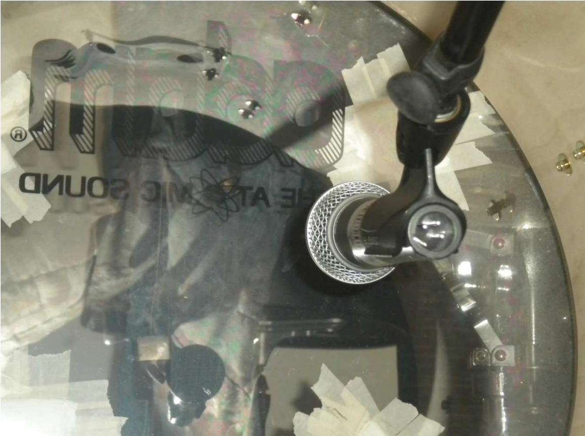
*Fig.4: Fotografía del Micrófono Shure SM58 ubicado en el desfogue del kick*
