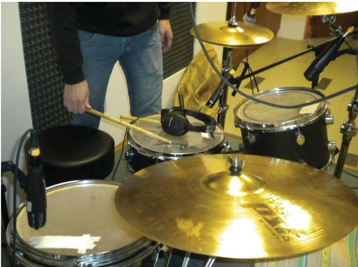
*Fig.15: Fotografía del Tom de piso con el micrófono Sennheiser MD421. Obsérvese el micrófono ubicado en posición vertical invertida en la parte izquierda inferior de la foto.*
