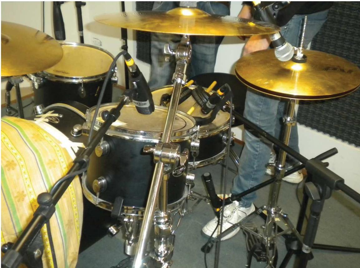
*Fig.14: Fotografía del Snare con el micrófono Shure SM57. Vista lateral. Fijarse en el micrófono que se encuentra en la parte de abajo del Snare.*
