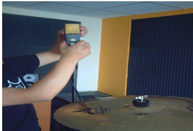
Figura 12. Se ubica el transductor AKG 414 a unos 50 cm del overhead
