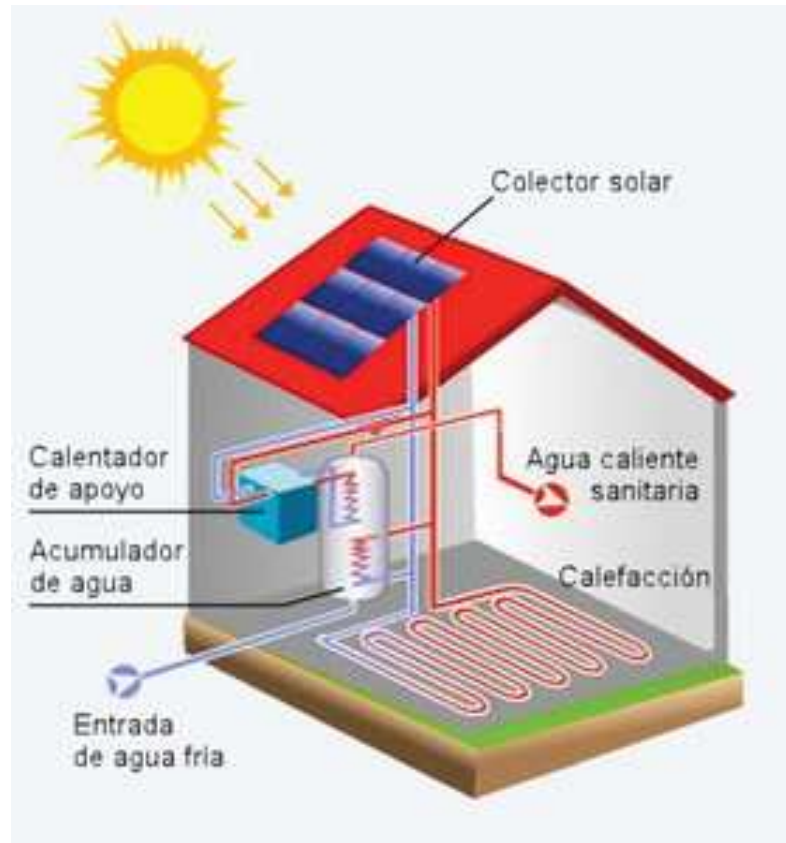
Figura 1. Funcionamiento del calentador solar de agua.
