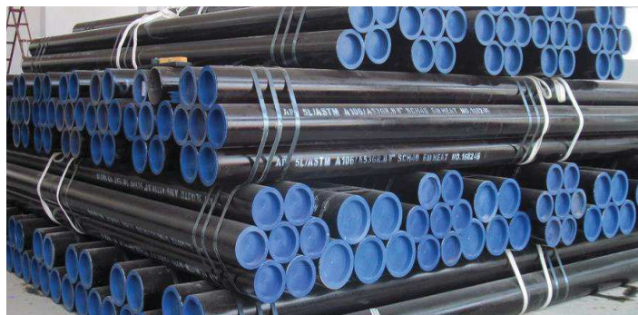
Figura 9 Embalaje de tubería de acero sin costura
