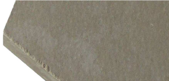
Figura 13. Plancha de fibrocemento.
