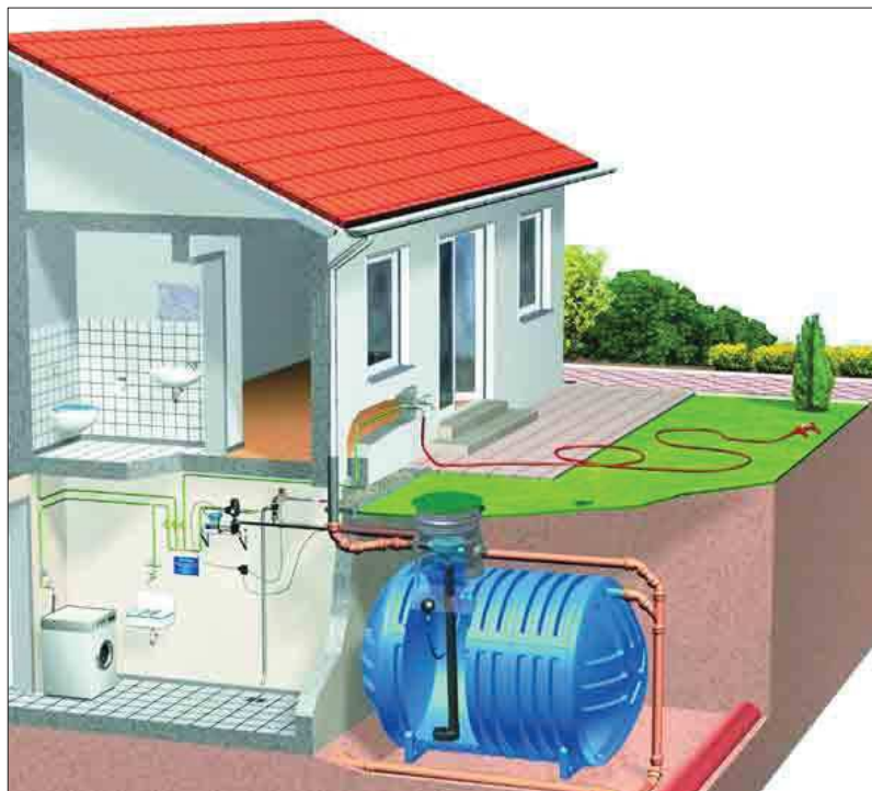
Figura 37: Diseño final del sistema de recolección y tratamiento básico de agua lluvia
