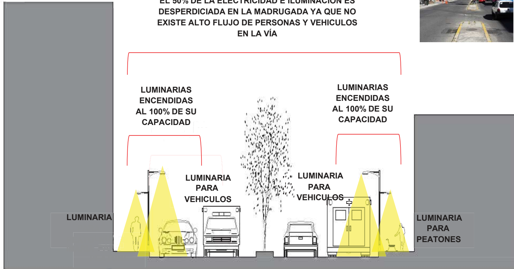
Figura 62. Formato vial e iluminación
