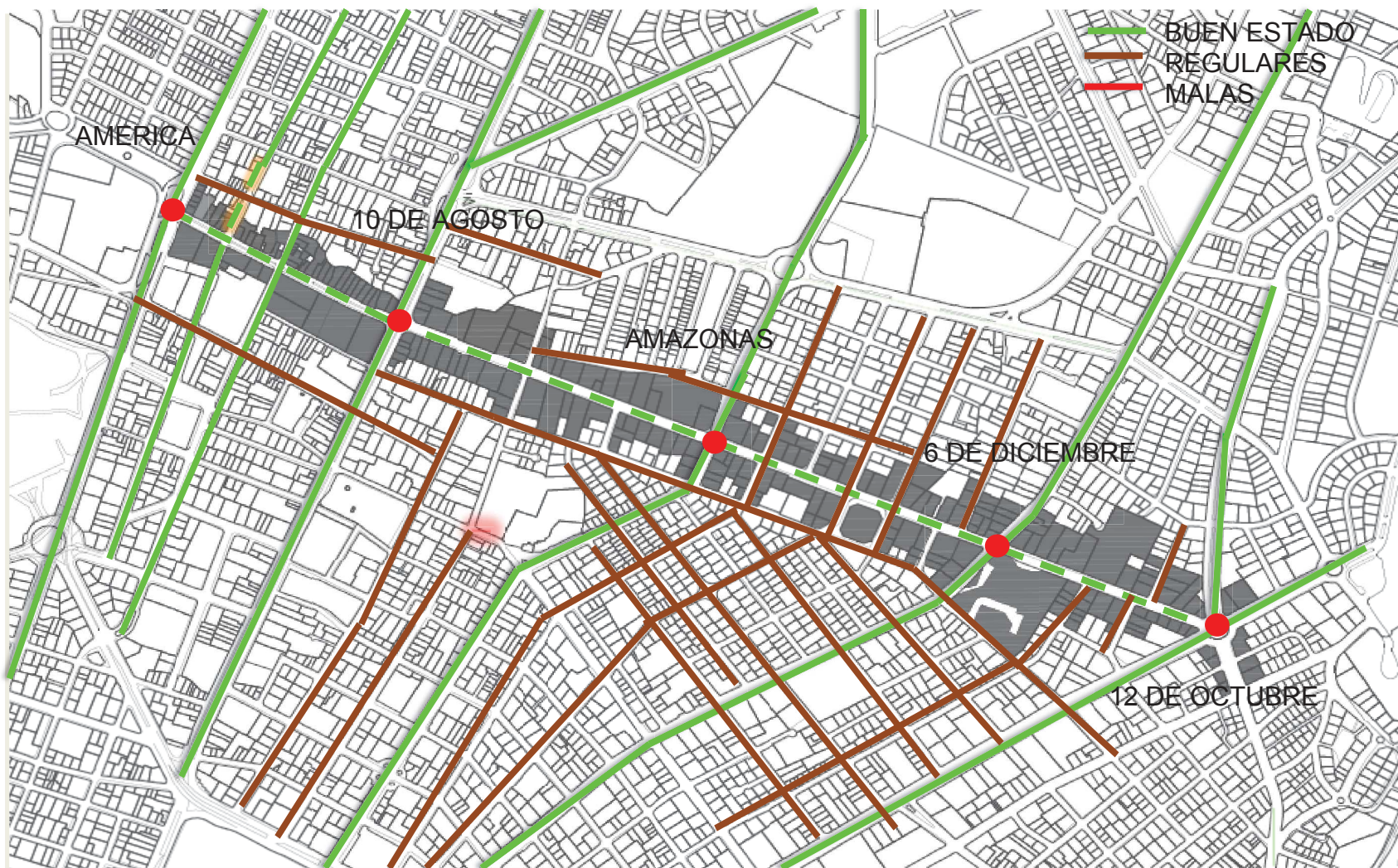
Figura 58. Estado actual de las vías
