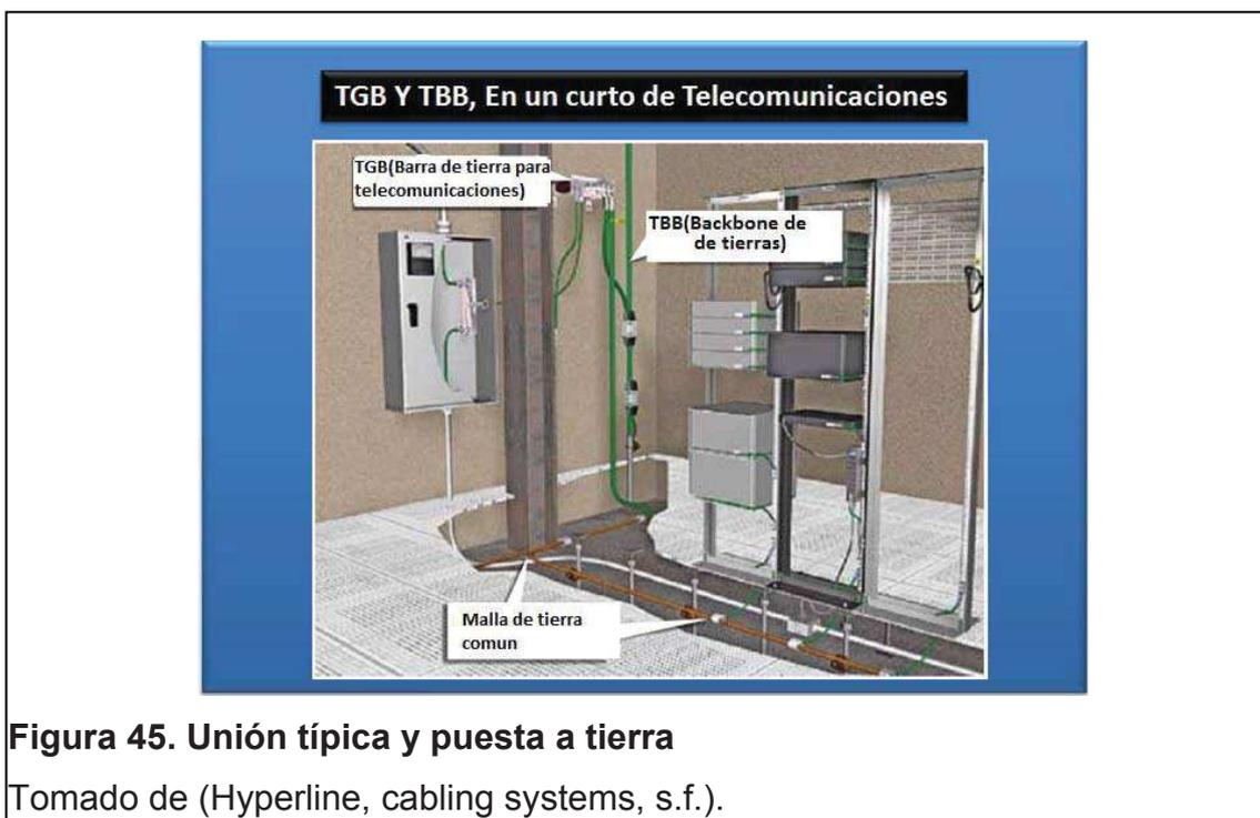
**Figura 45. Unión típica y puesta a tierra**
