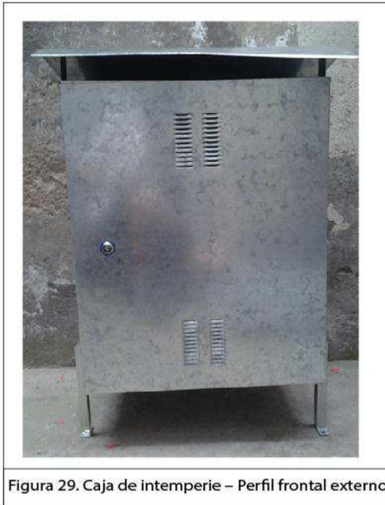
El techo de la estructura sobresale con 10cm en la parte frontal y 14cm en la parte posterior, además tiene inclinación tanto en la parte frontal como en la posterior para que de esa manera el agua pueda resbalar en caso de lluvia y termine en el suelo evitando así que de ninguna manera ingrese al interior de la caja de intemperie y ocasione de esta manera daños en los equipos.
