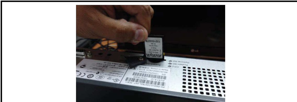
Figura 26. Insertar tarjeta SD en chasis Avaya IP Office 500 V2
