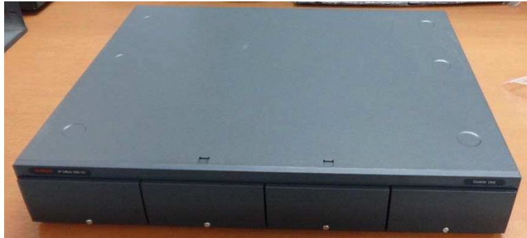
Figura 21. Vista Frontal del chasis Avaya IP Office 500v2
