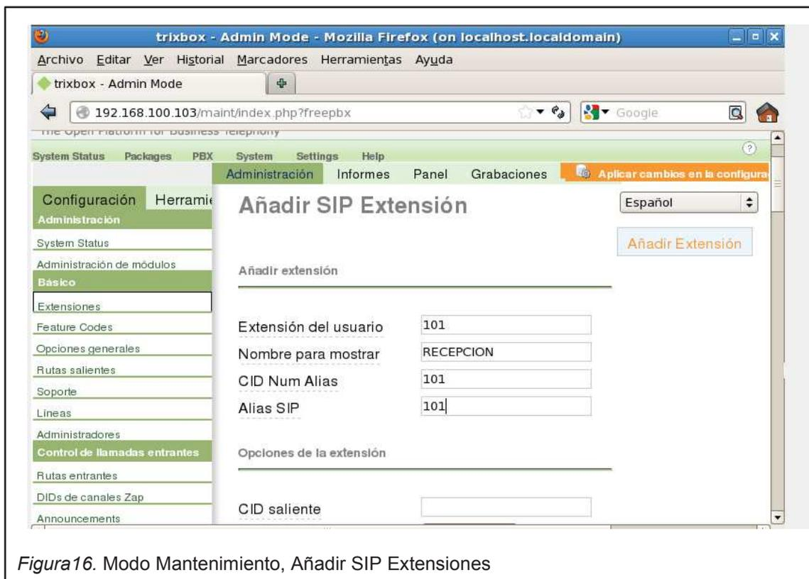
Figura16. Modo Mantenimiento, Añadir SIP Extensiones
