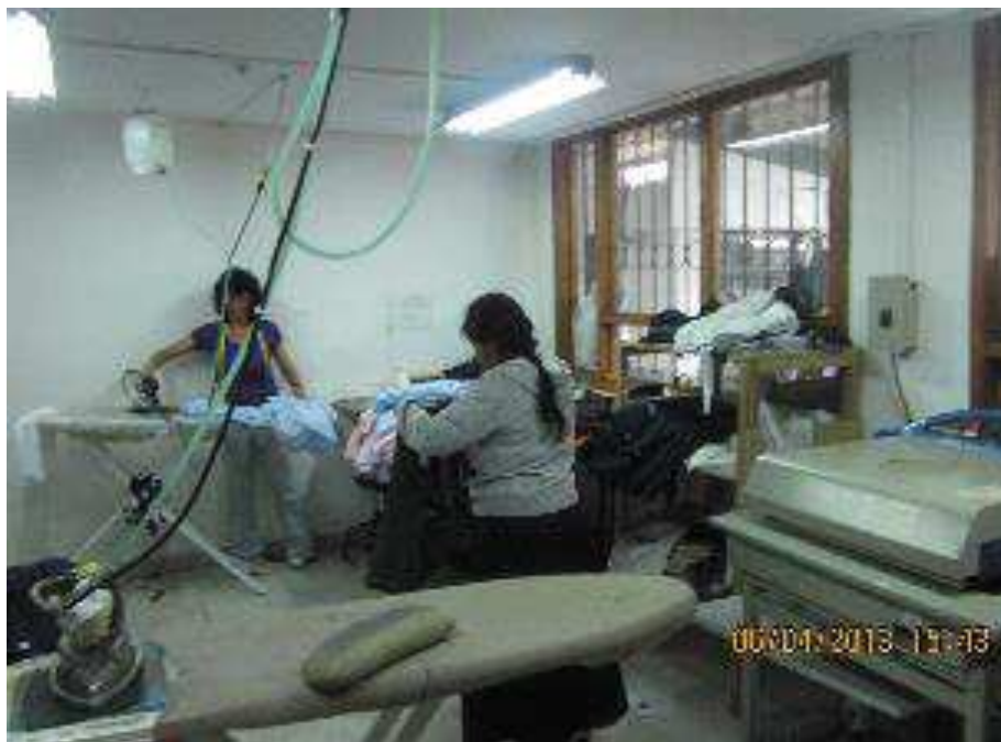
Figura 7. Ventilación Insuficiente originada por las planchas
