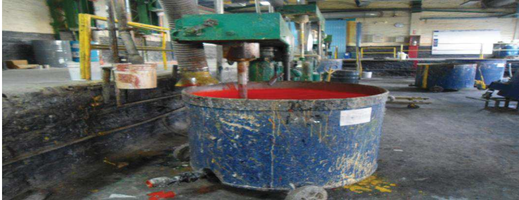
FIGURA 19. PROCESO DE DISPERSIÓN Y DILUCIÓN DE PIGMENTO PINTURAS CONDOR
