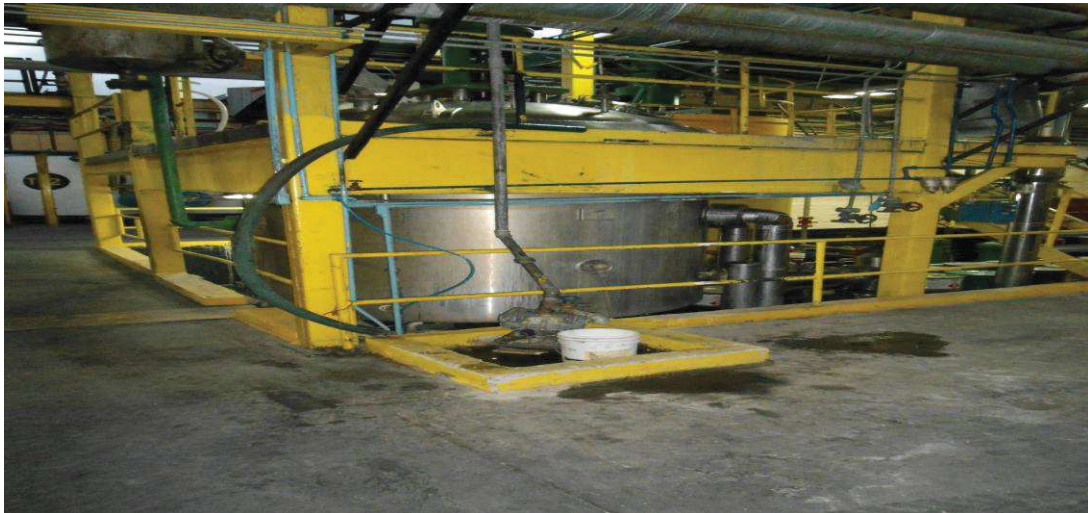
FIGURA 1. REACTOR MQ-4 EN EL CUAL SE FABRICA RESINAS ALQUÍDICAS Y POLIESTER PINTURAS CONDOR
