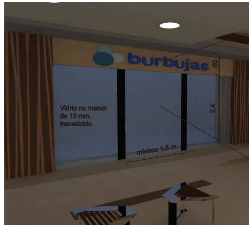
Figura 70. Dimensiones de una Fachada Tipo
