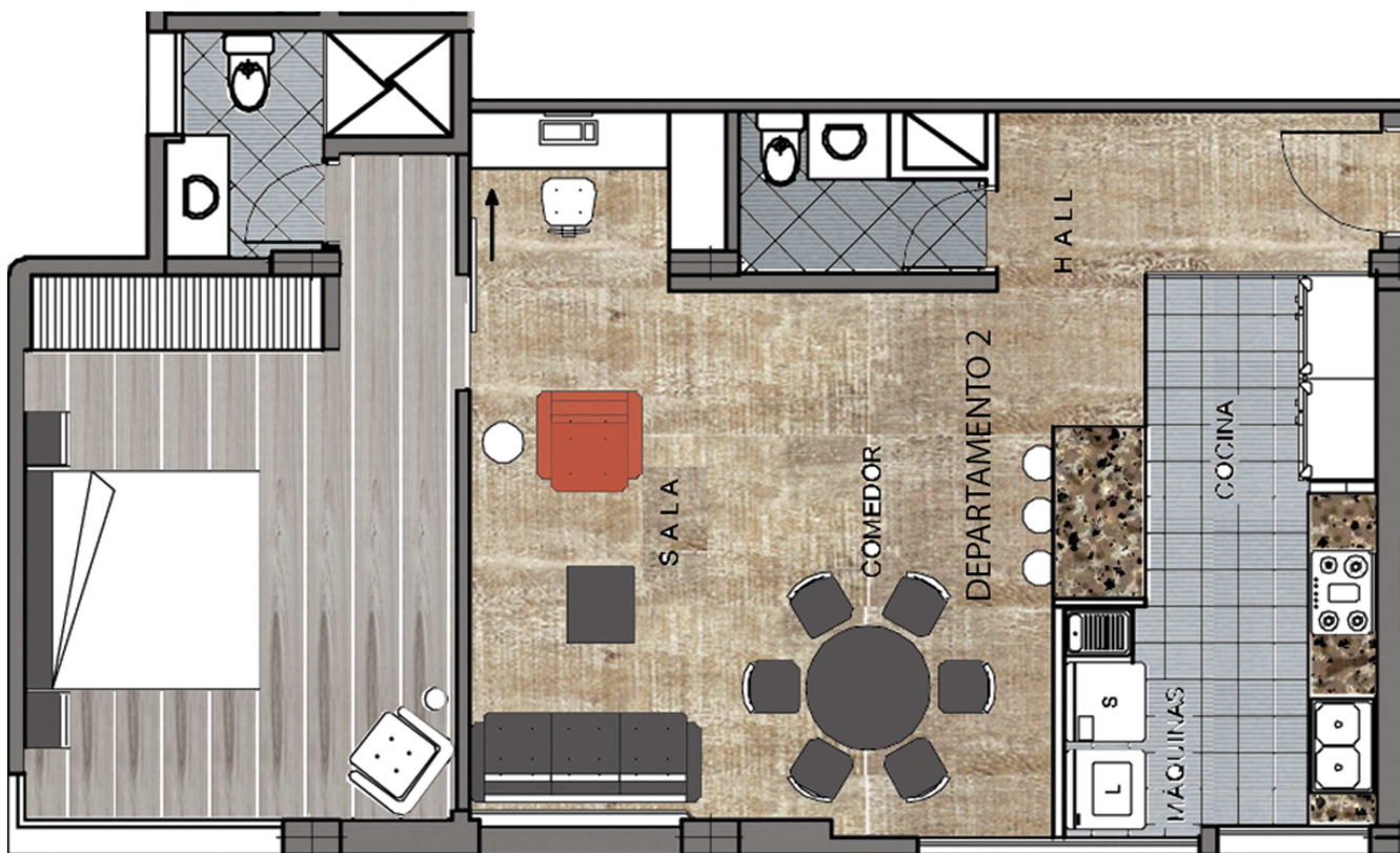
PLANTA SECCIONADA DEPARTAMENTO 2
