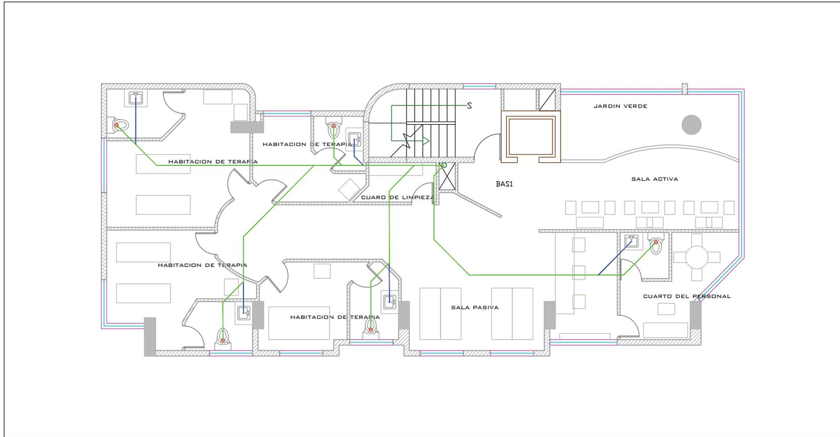
PLANTA INSTALACIONES DE DESCARGA DE LA PLANTA TIPO
