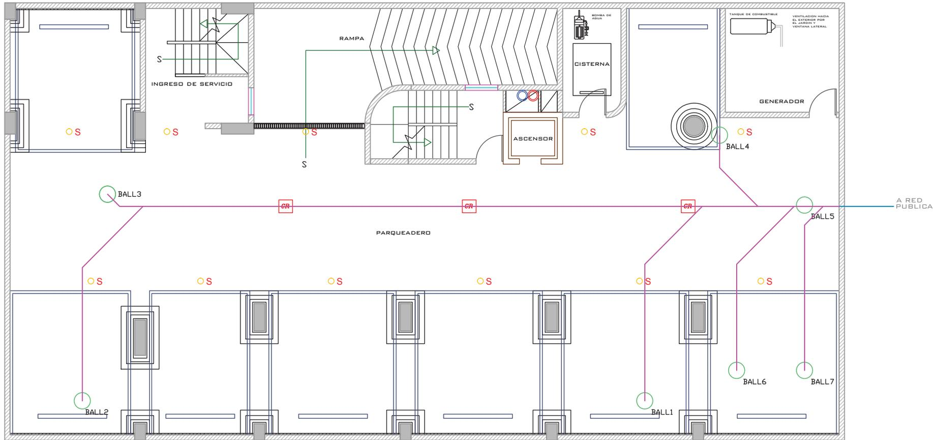
PLANTA DE INSTALACIONES DE AGUA LLUVIA DEL SUBSUELOS - ESTACIONAMIENTOS
