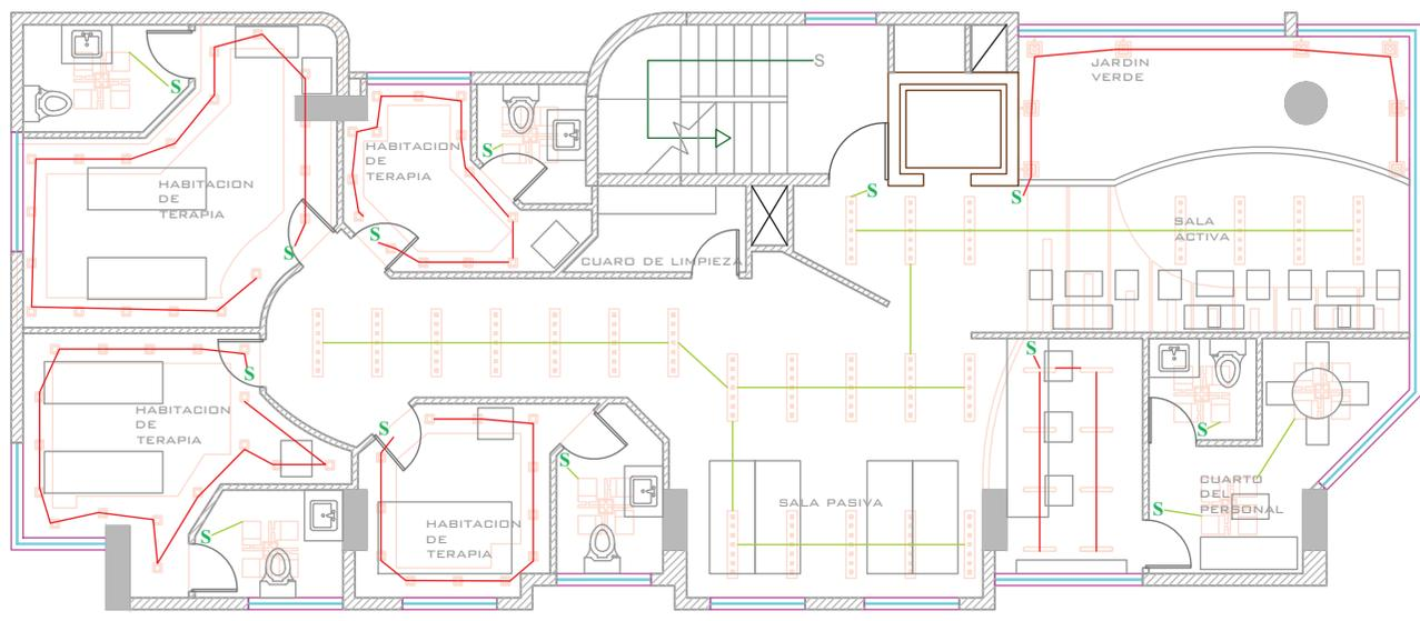
PLANTA DE INSTALACIONES ELECTRICAS DE LA PLANTA TIPO
