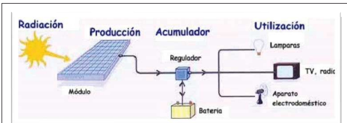
Figura 19. Una instalación solar fotovoltaica sin inversor, utilización a 12Vcc Tomado de Energía Solar, 2010
