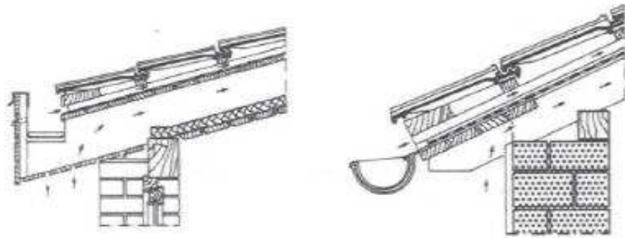
6 Ventilación de la cubierta a través de las juntas del revestimiento de madera
