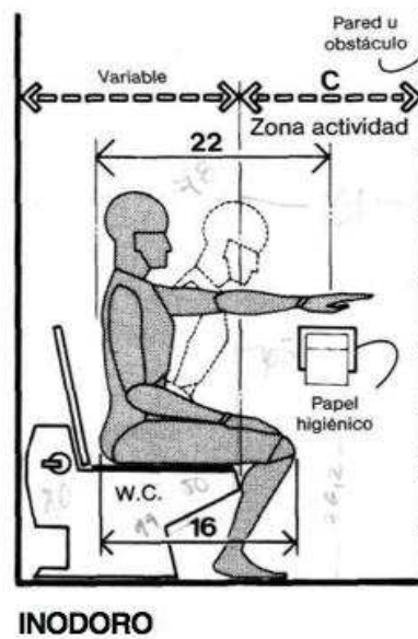
Figura 81. Análisis de funcionamiento de inodoro Tomado de Panero J. Y Zelnik M., 2012.
