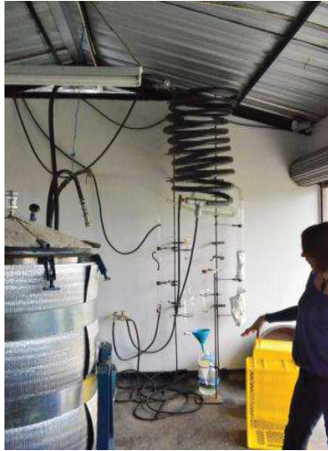
Figura 2. Máquina de Destilación Por Arrastre Tomado de ISABRU.
