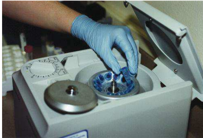
Figura 6. Máquina para centrifugar aceites esenciales Tomado del Proyecto Biosfera
