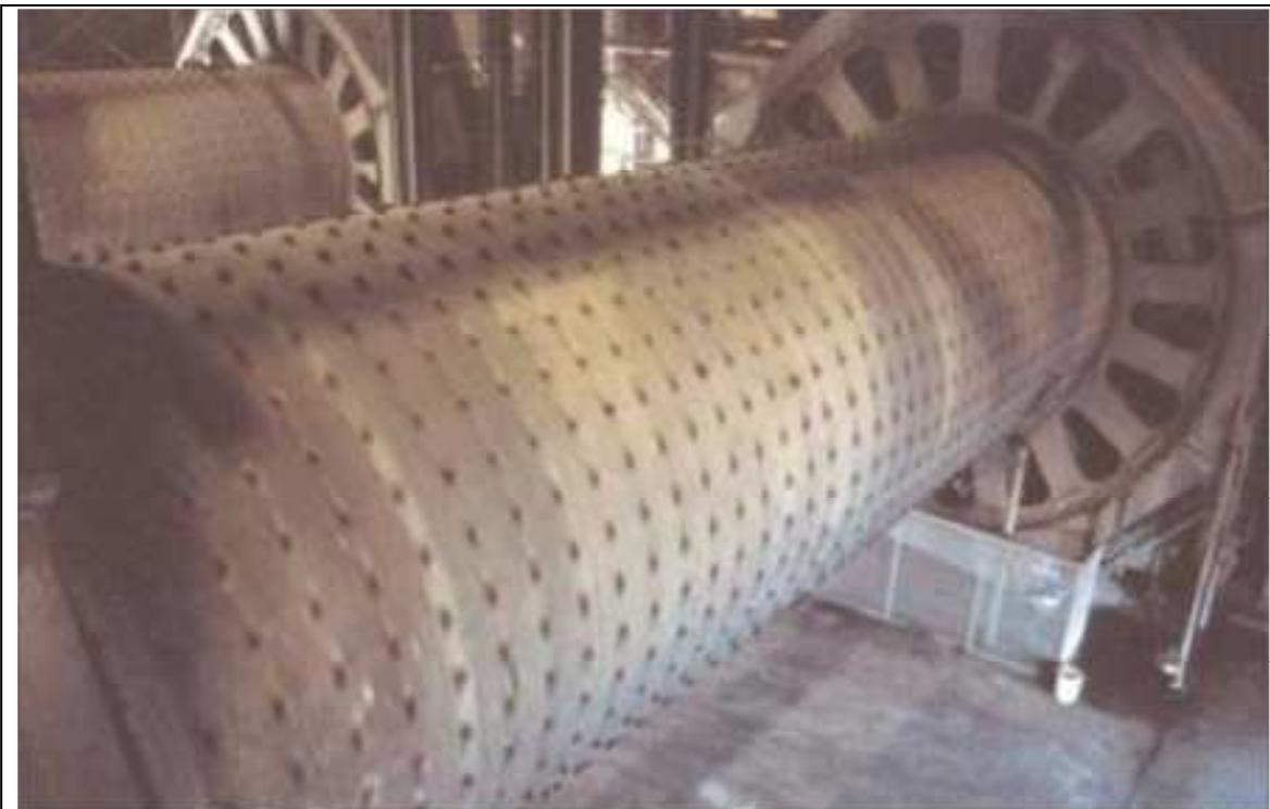
Figura 8 Molinos de bolas en planta de Producción de Cemento (BATTHY, Javed I, 2004, págs. 499-504)
