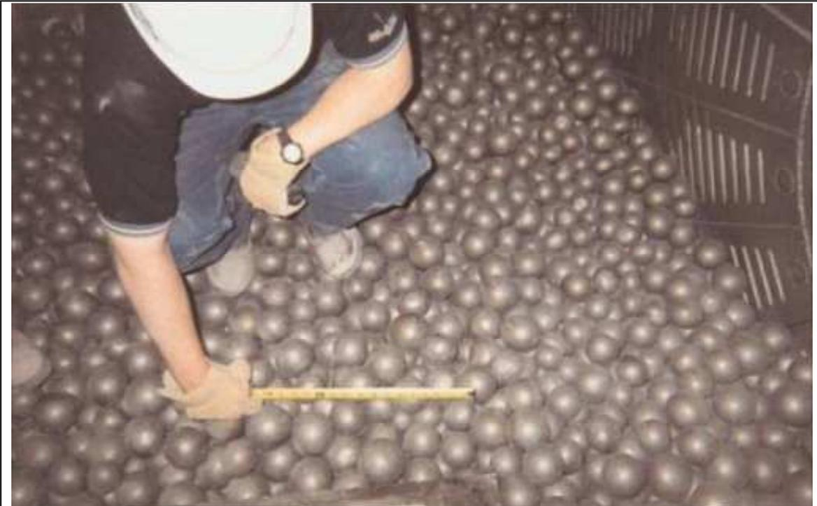
Figura 7 Detalle de interior molino de Bolas (BATTHY, Javed I, 2004, págs. 499-504)
