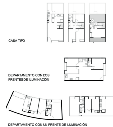
Figura 123. Tipología de Vivienda Proyecto Cumbres de Quitumbe. Tomado de (Plataforma Arquitectura, s.f.) http://www.plataformaarquitectura.cl/2009/02/07/cumbres-de-quitumbe-patricio-endara/
