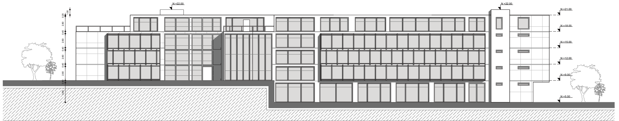
FACHADAS FRONTAL EDIFICIO DE VIVIENDA ESC. _____ 1:300
