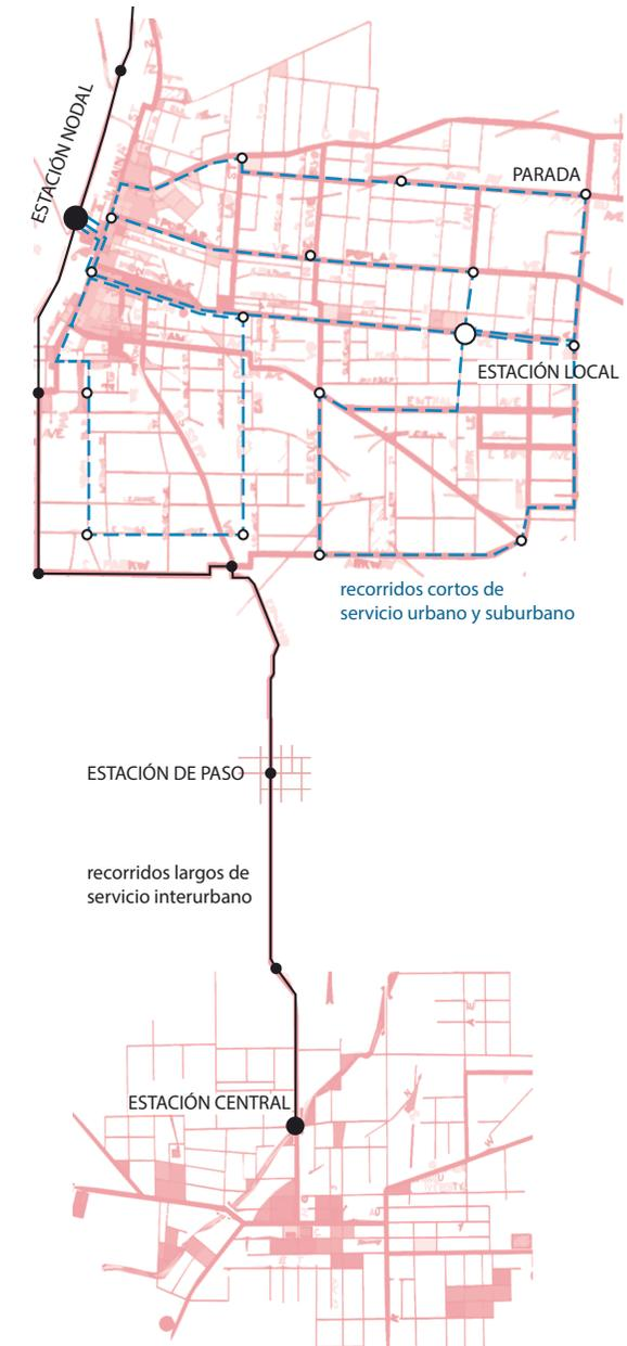
Figura 49. Esquema de Tipos de Estaciones según su función.
