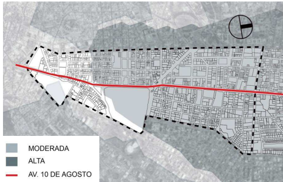
Figura 52. Licuefacción del Suelo Tramo 1 Tomado de Documento POT 2013
