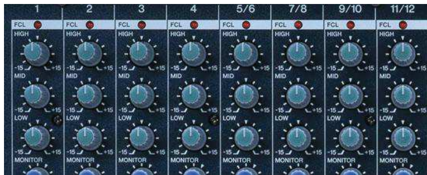
Figura 2.18. Sección de Ecuación de una mezcladora de tres bandas ( Low, Mid, High )
