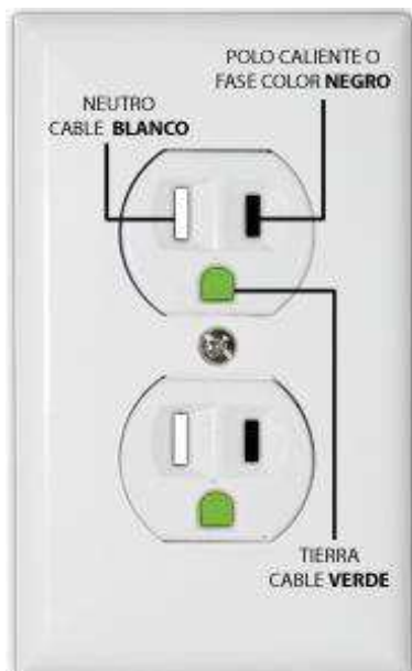
Figura 2.7. Ilustración de los terminales de un tomacorriente y toma a tierra.
