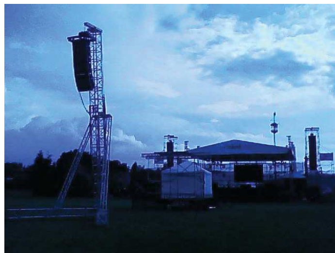
Figura 3.33. Torre de delay colocada para el Quito fest 2010 a 50 metros de distancia.
