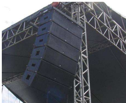
Figura 4.13. Sistema line array del Pucetón 2010.
