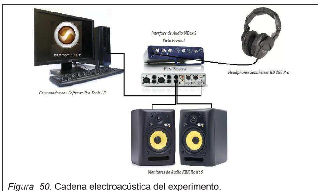
La figura 50 indica la cadena electroacústica implementada en el experimento. En el software Pro Tools LE 8.0.4 se encuentran previamente colocadas las muestras de audio que se utilizarán en la investigación, estas han sido cortadas en las partes más relevantes de cada canción, generalmente el coro. Así mismo el nivel de ganancia de todas las muestras se ha igualado, para que no exista una diferencia en la percepción auditiva de estas, que pueda perjudicar en la apreciación de cada tema.
