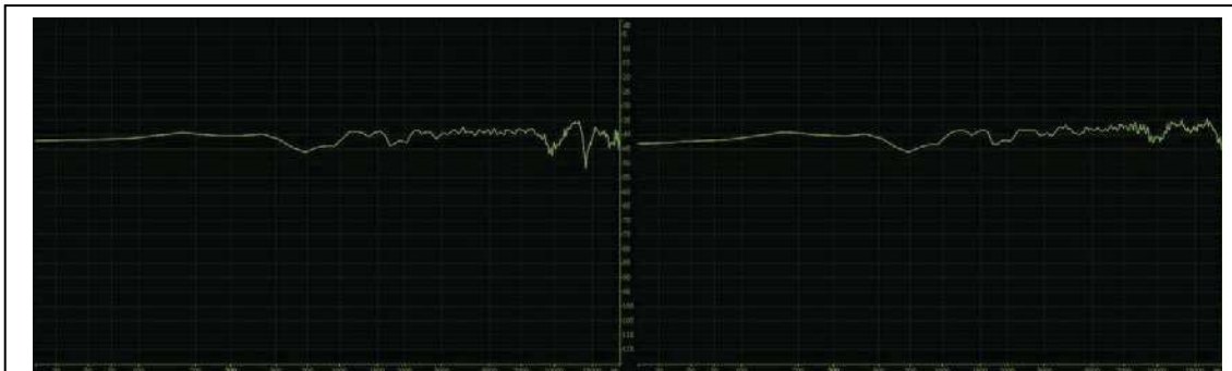
Figura 52. Espectro sonoro de la señal obtenida en la posición acimut 0°, elevación 60° para los canales izquierdo y derecho respectivamente.
