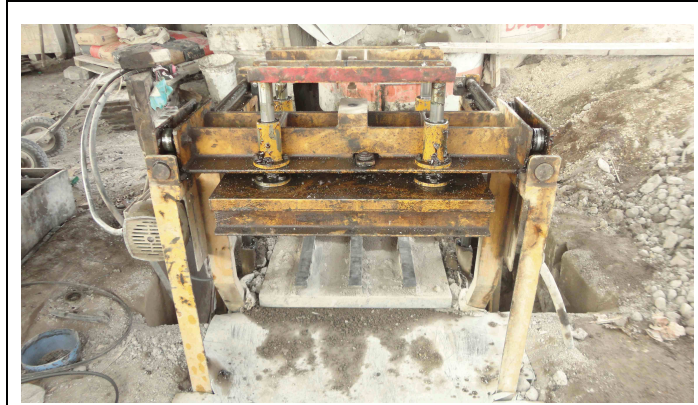
Figura 19. Bloquera con Prensado Hidráulico y Vibración en 2 Ejes
