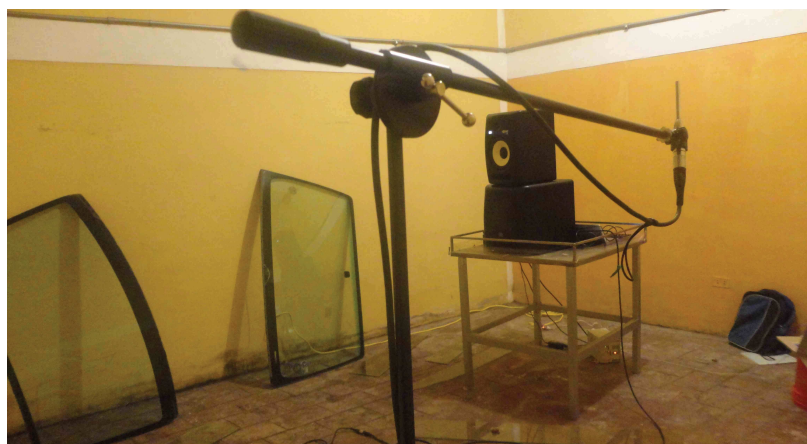
Anexo 41 Medición T60 Cámara Vacía 2
