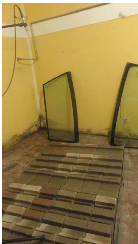
Anexo 47 Medición de T60 con la Muestra de Ensayo 2
