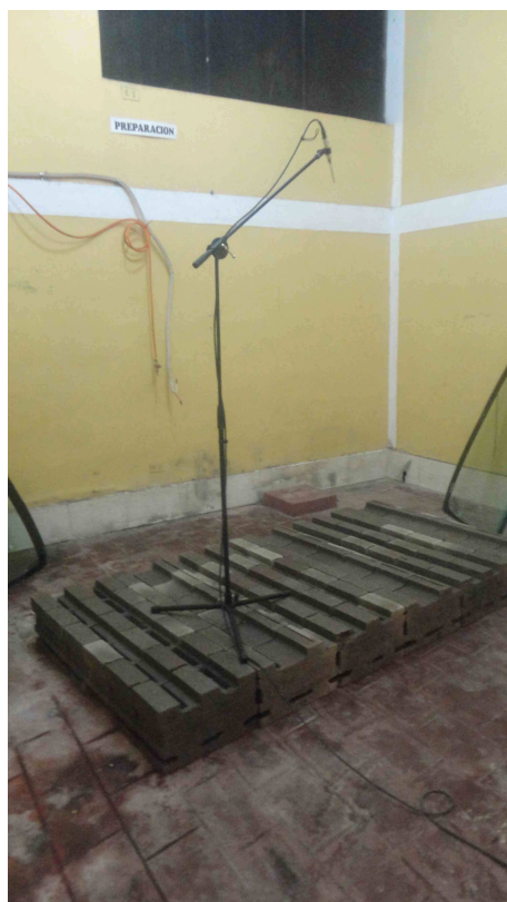
Anexo 49 Medición de T60 con Muestra de Ensayo (Sala Inestable Frecuentemente)
