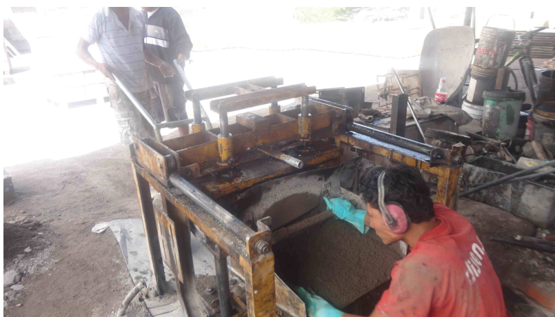
Anexo 30 Proceso de Fabricación de la UMC Acústica 2
