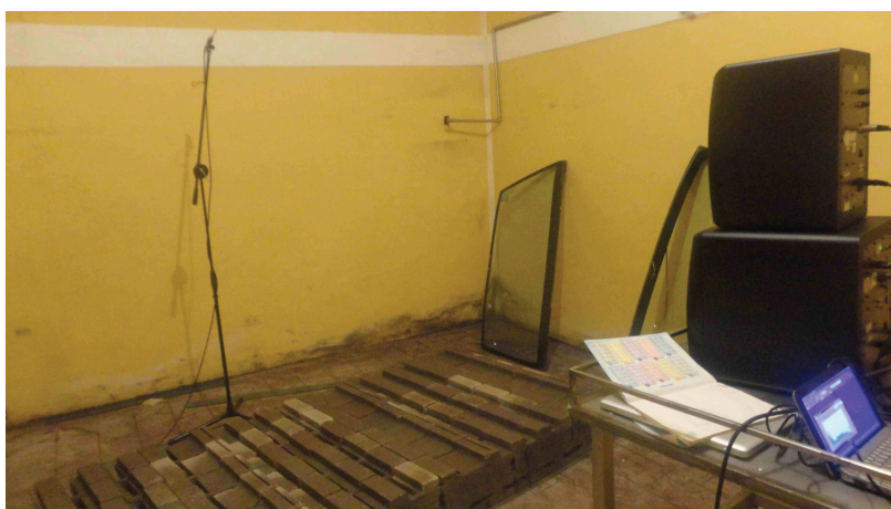
Anexo 45 Medición de T60 con la Muestra de Ensayo 1
