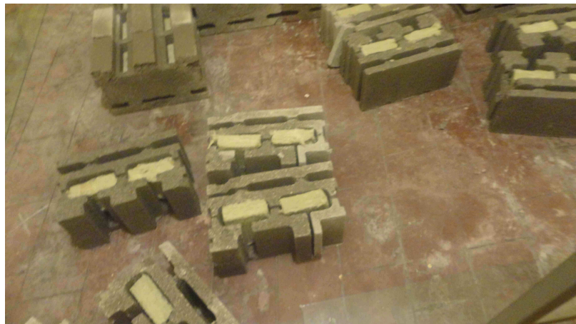
Anexo 42 Implementación de la Lana Mineral en la Cavidad de la UMC
