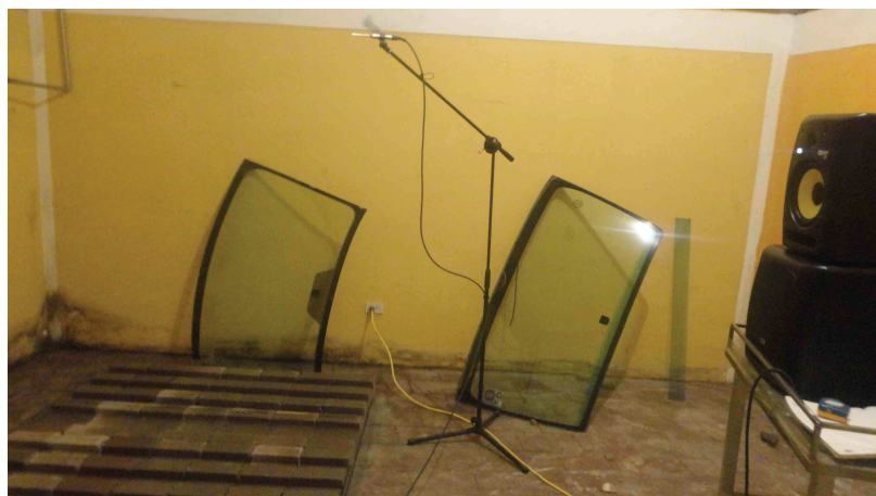
Anexo 51 Medición de T60 con la Muestra de Ensayo 4
