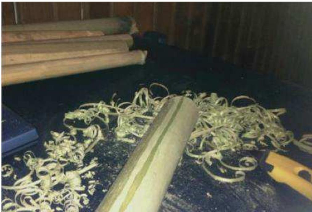
*Figura 37.* Fotografía de un entrenudo de bambú semi-pelado.
