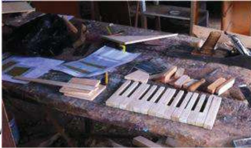
*Figura 43.* Fotografía de las teclas en el proceso de corte.
