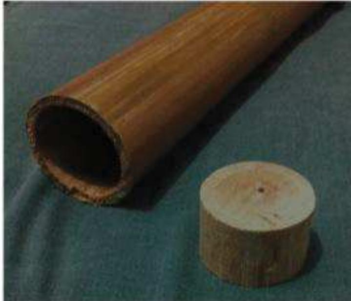
*Figura 22.* Fotografía de un tubo de bambú junto al tapón perforado de madera (eucalipto).
