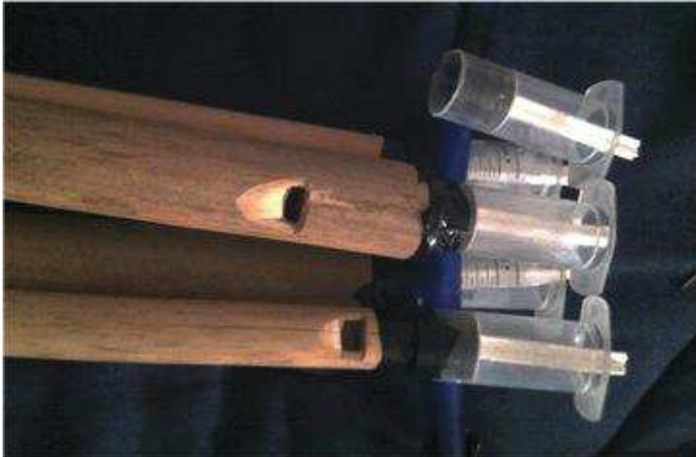
*Figura 25.* Fotografía de sistema de válvulas conectadas a los tubos sonoros.
