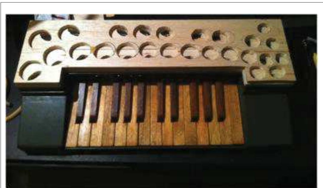
*Figura 49.* Plancha de madera perforada en función de la distribución de los tubos sonoros.
