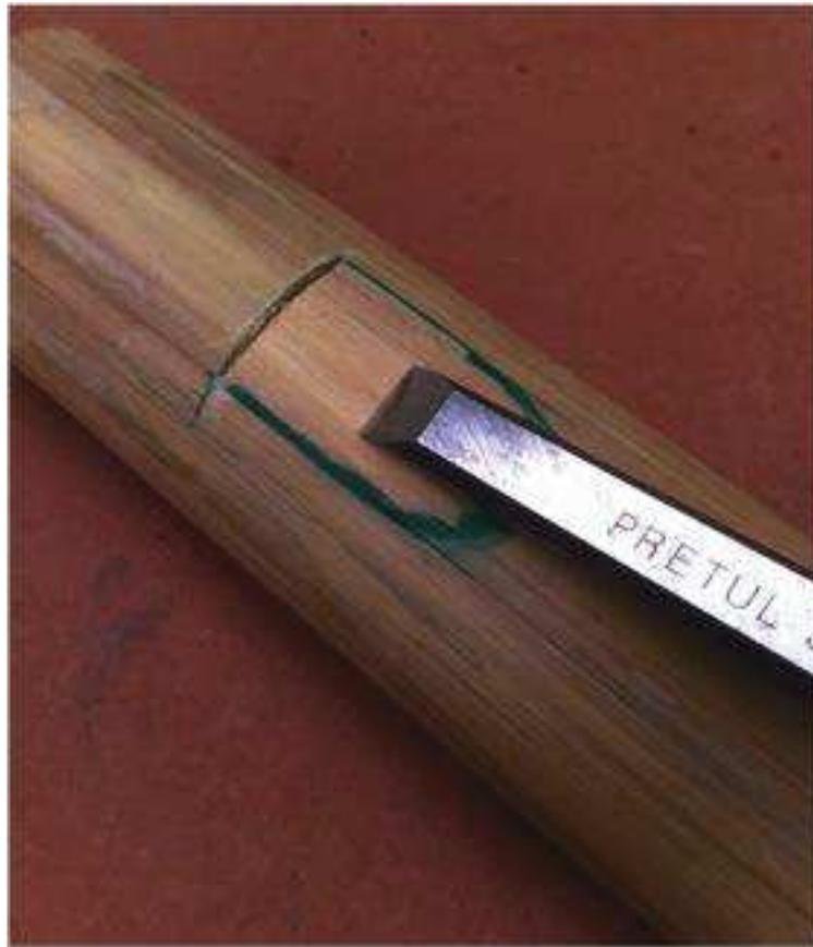
*Figura 20.* Fotografía que ilustra la construcción de la embocadura de un tubo de bambú.
