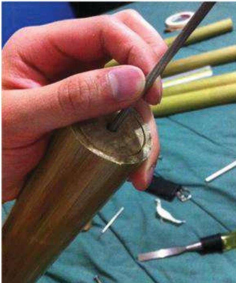
*Figura 39.* Proceso de afinación aumentando el diámetro del orificio inferior del tubo.
