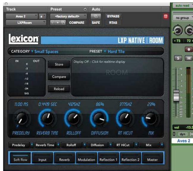
Figura 62. Configuración para crear espacialidad al efecto monofónico de una puerta mediante el uso del plugin LXP Native de Lexicon
