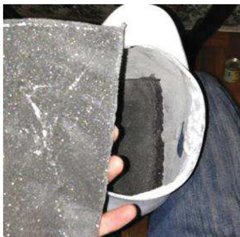
*Figura 23.* Relleno de la parte interna de la cabeza de maniquí con espuma de poliuretano
