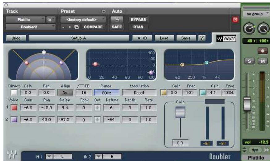
*Figura 59.* Configuración del efecto de doblaje mediante el uso del pitch shifter Doubler2 de Waves
