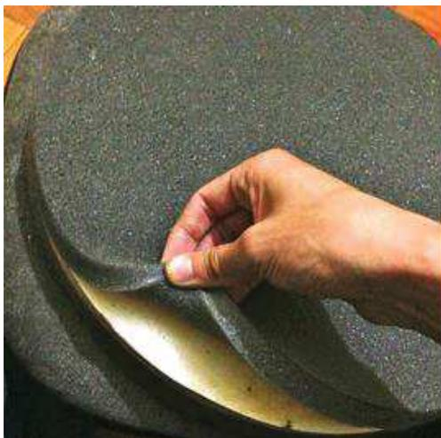
*Figura 28.* Colocación de la espuma de poliuretano en ambas caras del disco de madera
