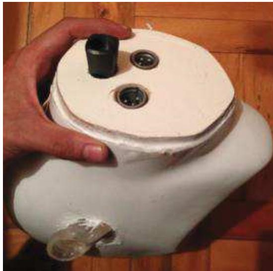
*Figura 24.* Proceso de sellado de la Dummy Head con su base
